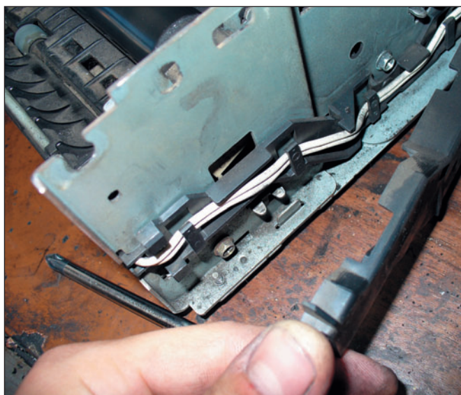
Рис. 19. В нижней части к печке по желобу подходят провода
