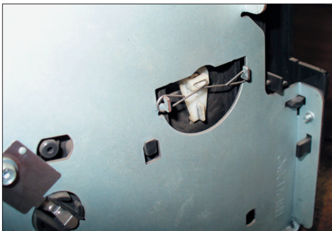
Рис. 6. Снимаем пружину, поворачиваем и вытаскиваем втулку
