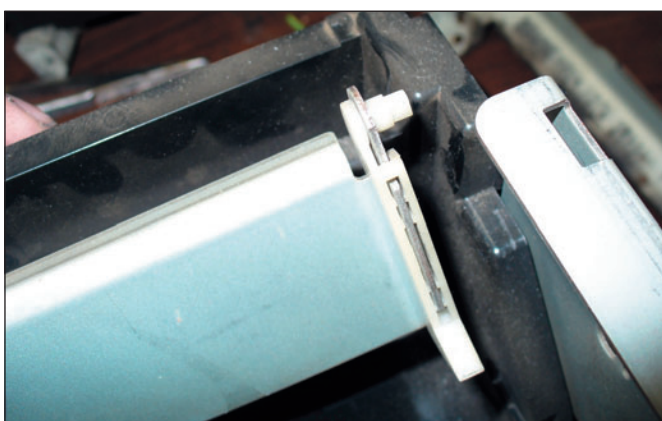
Рис. 9. Вот эта стенка подталкивает листы в принтер
