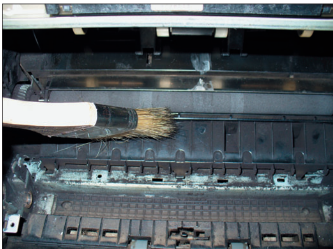
Рис. 24. Чистим пальцы снятия заряда, которые находятся сразу за валом переноса изображения
