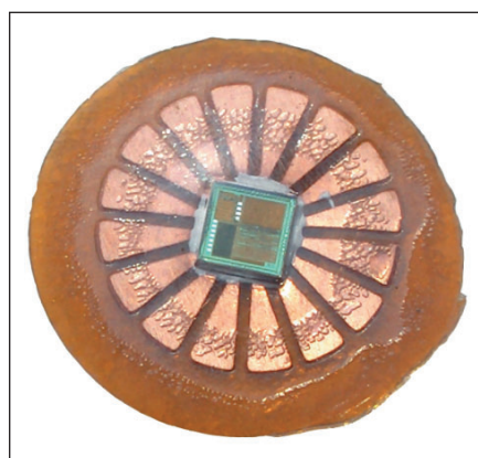
Увеличенное изображение пластины Memory-Spot (диаметр около 1,2 см)
