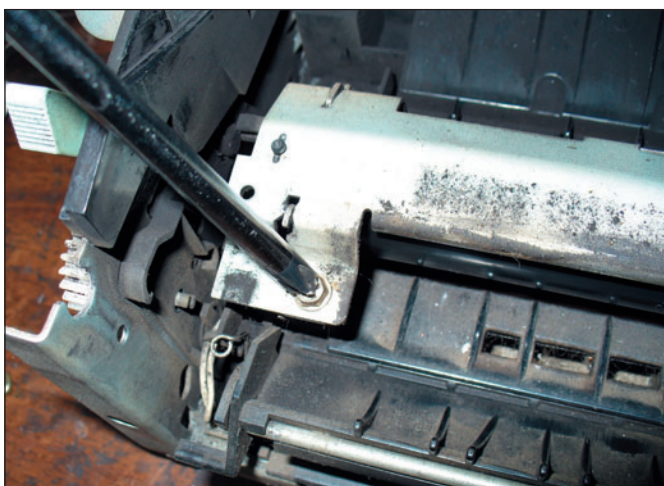
Рис. 17. Еще одна часть защитного кожуха, которая тоже служит для прижима
