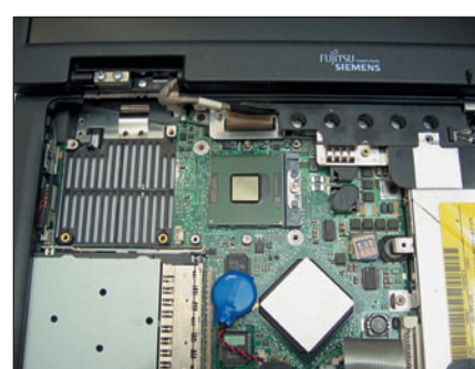
Устанавливаем новый процессор, покрываем поверхность кристалла термоинтерфейсом и собираем ноутбук в обратной последовательности
