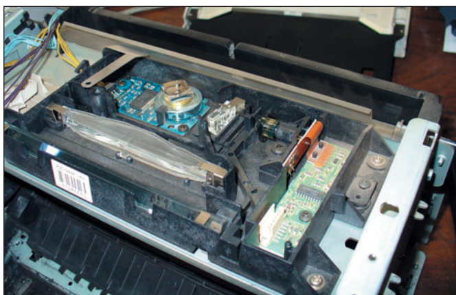
Рис. 22. Вот так выглядит блок лазера изнутри
